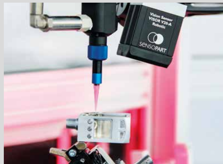
Der VISOR® Robotic ermittelt präzise die Lage des Sensorgehäuses. Die Offsetdaten werden dazu verwendet, um die Roboterbahn zu korrigieren.
