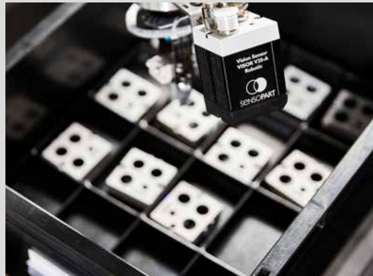
Der VISOR® Robotic detektiert die Lage des Bauteils in einem Universaltray. Die Entnahme kann somit sicher erfolgen. Über bis zu 255 Konfigurationen erreicht man eine hohe Flexibilität für die Fertigung.
